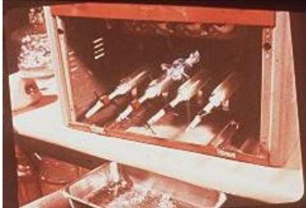
Diese Maschine raucht jeden Tag 2.000 Zigaretten und imitiert dabei das Muster, nach dem ein Raucher inhaliert, um so eine vergleichbare Menge Teer abzuschöpfen. Innerhalb eines Tages schöpft die Maschine die unten abgebildete Menge Teer ab.
